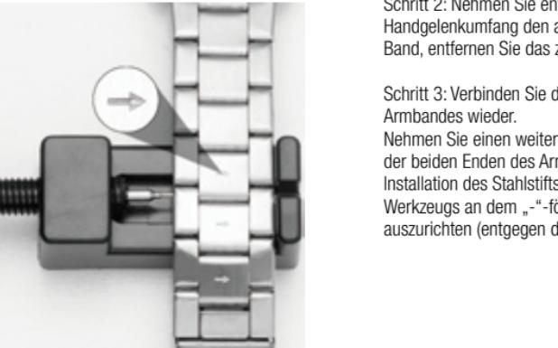
3. Entfernen Sie sie in Pfeilrichtung. Wenn der Stahlstift eine runde Form aufweist, ist dies die Richtung zum Entfernen. Wenn der Stahlstift eine „-“-Form aufweist, ist dies die Ausrichtung zur Installation (entgegen der Pfeilrichtung).
